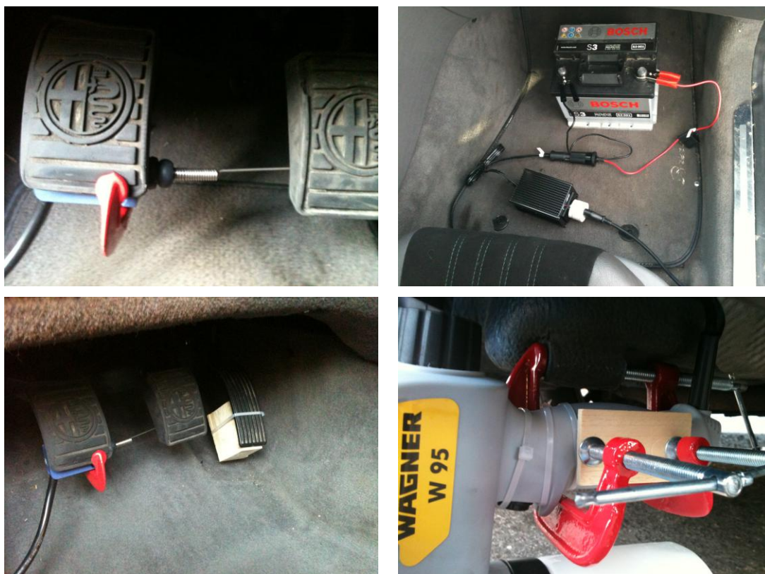
Figura 5: Dettagli sullo strumento utilizzato per la rilevazione della lunghezza dello spazio di frenata F , montato sull'Alfa Romeo Brera (in alto a sinistra il microswitch, in alto a destra l'accumulatore e l'inverter, in basso a sinistra gli spessori modulari, in basso a destra l'emettitore di vernice ancorato alla scocca del veicolo).
