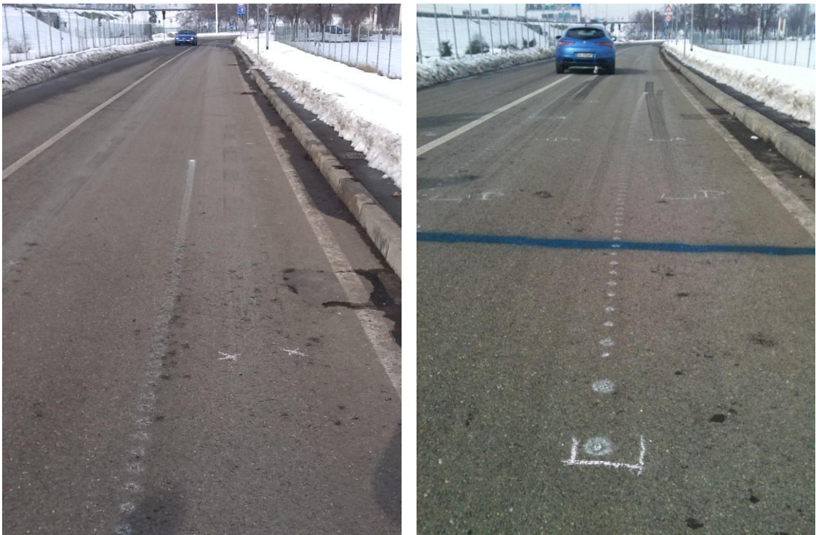
Figura 7: Prova di frenata con ABS inserito (a sinistra) e disinserito (a destra). Si notino, oltre alla scia di vernice, le differenti tracce gommosse impresse.
