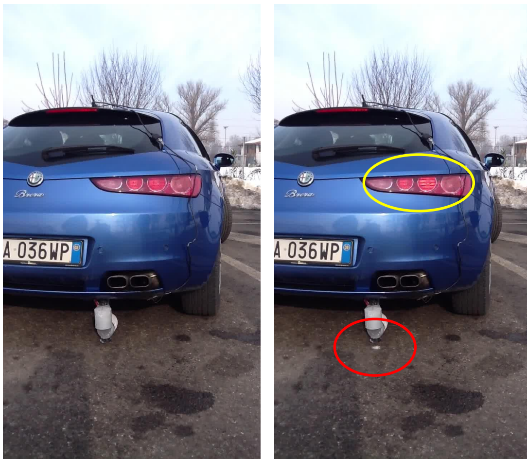
Figura 6: Esempio di verifica del sincronismo tra schiacciamento del pedale del freno ed inizio tracciamento della scia di vernice. Dal filmato emerge sostanziale sincronismo. Si noti che l'asfalto era umido, con cumuli di neve in discioglimento ai lati della carreggiata.
