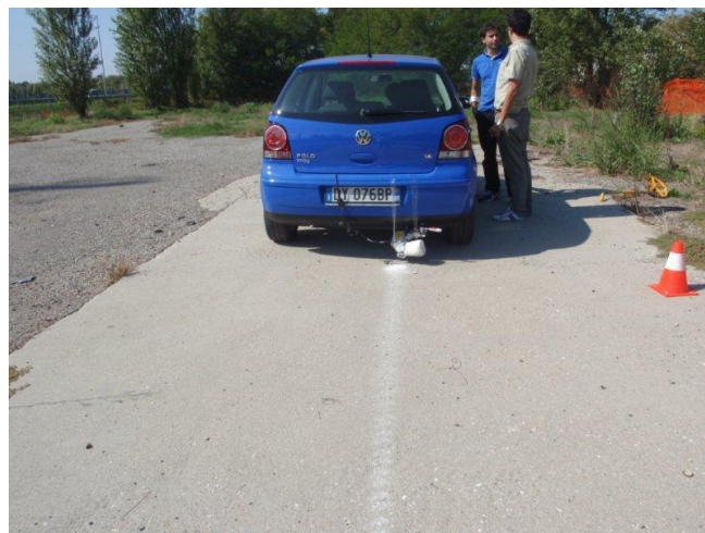
Figura 8: Prova di frenata su lastra in cemento.
