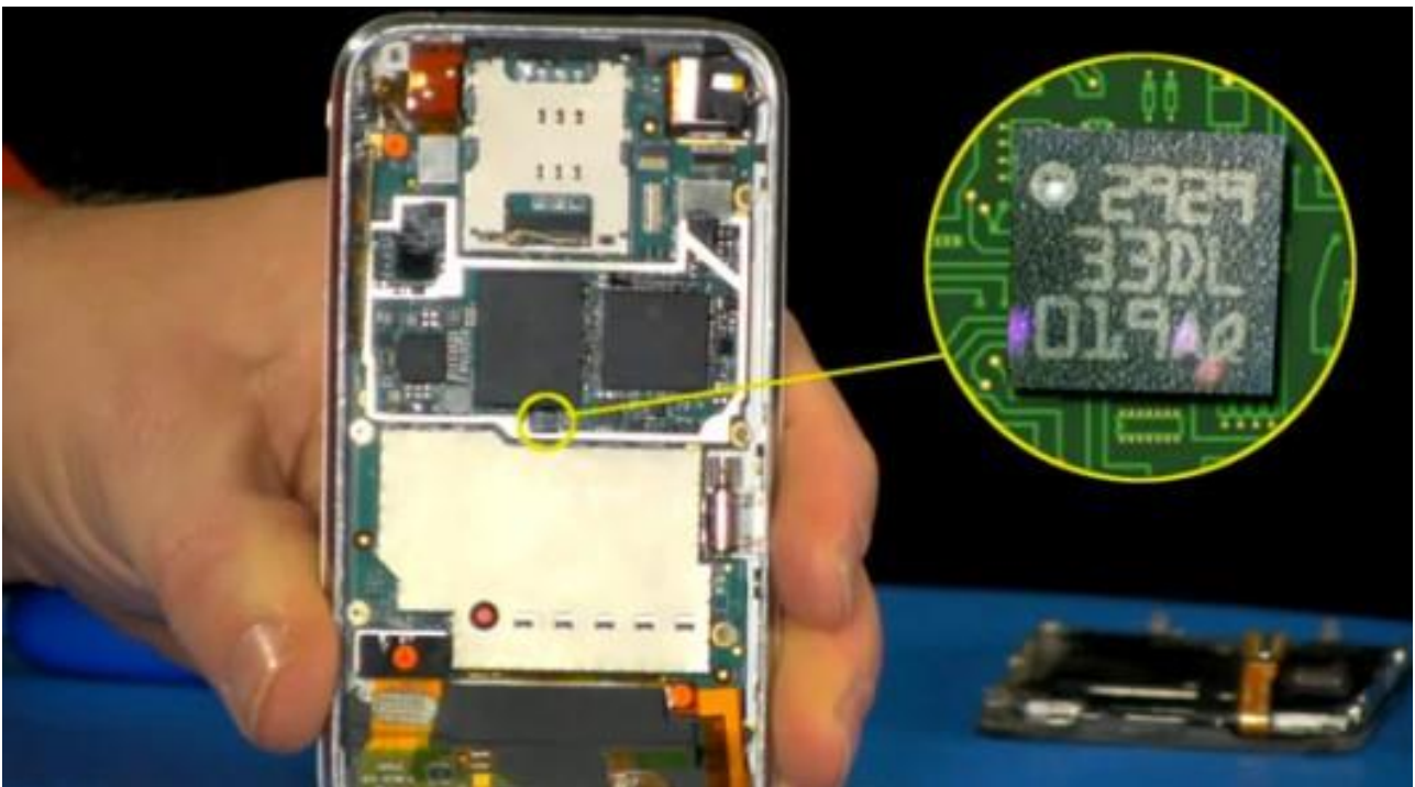
Figura 1: Il dispositivo accelerometrico disposto all'interno dello smartphone.
