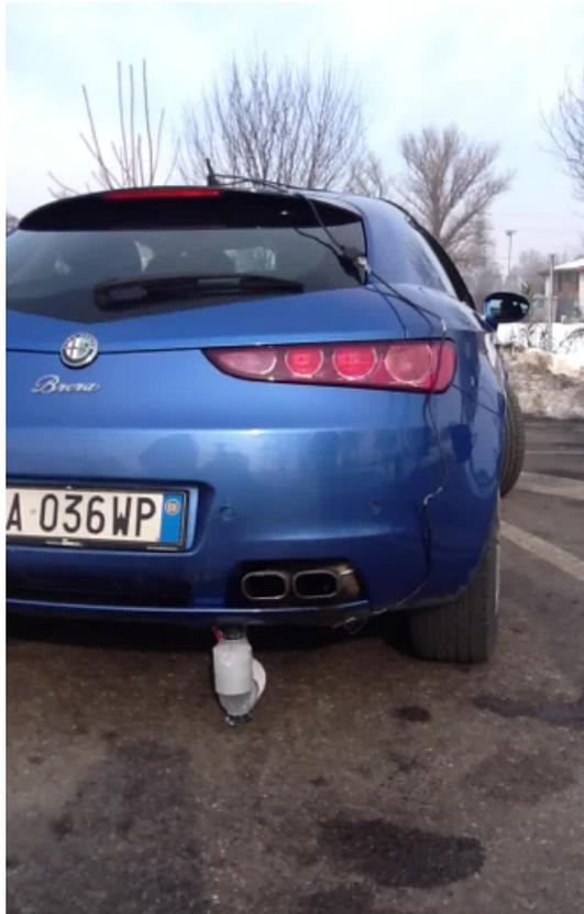
sistema tracciante montato su Alfa Brera
